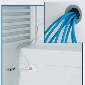
Passage de cuve Ø 15mm pour sonde GTC (Gestion Température Centralisée) PT100 ou numérique, et passage de cuve Ø 30mm pour caractérisation/qualification sur site positionné sur le côté droit à 1/3 du haut.
