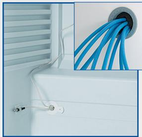
Passage de cuve Ø 15mm pour sonde GTC (Gestion Température Centralisée) PT100 ou numérique, et passage de cuve Ø 30mm pour caractérisation/qualification sur site positionné sur le côté droit à 1/3 du haut.
