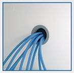
Passage de cuve Ø 30mm pour caractérisation/ qualification sur site. positionné sur la porte à 1/3
